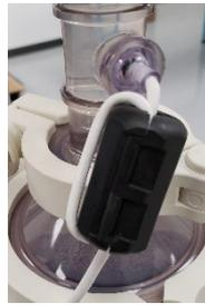
Pour installer une perle de ferrite fournie sur le capteur de pression d'un chemin d'écoulement :
